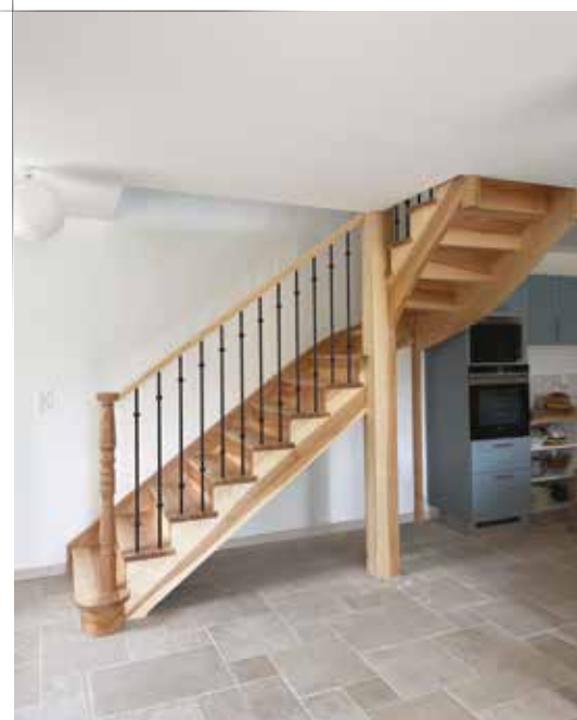
St-4 → Escalier 1/4 tournant en Frêne Olivier avec contremarches, marche de départ S3, poteau de départ tourné, main-courante MC3, sur crémaillère "à l'anglaise" avec limon de mur.
