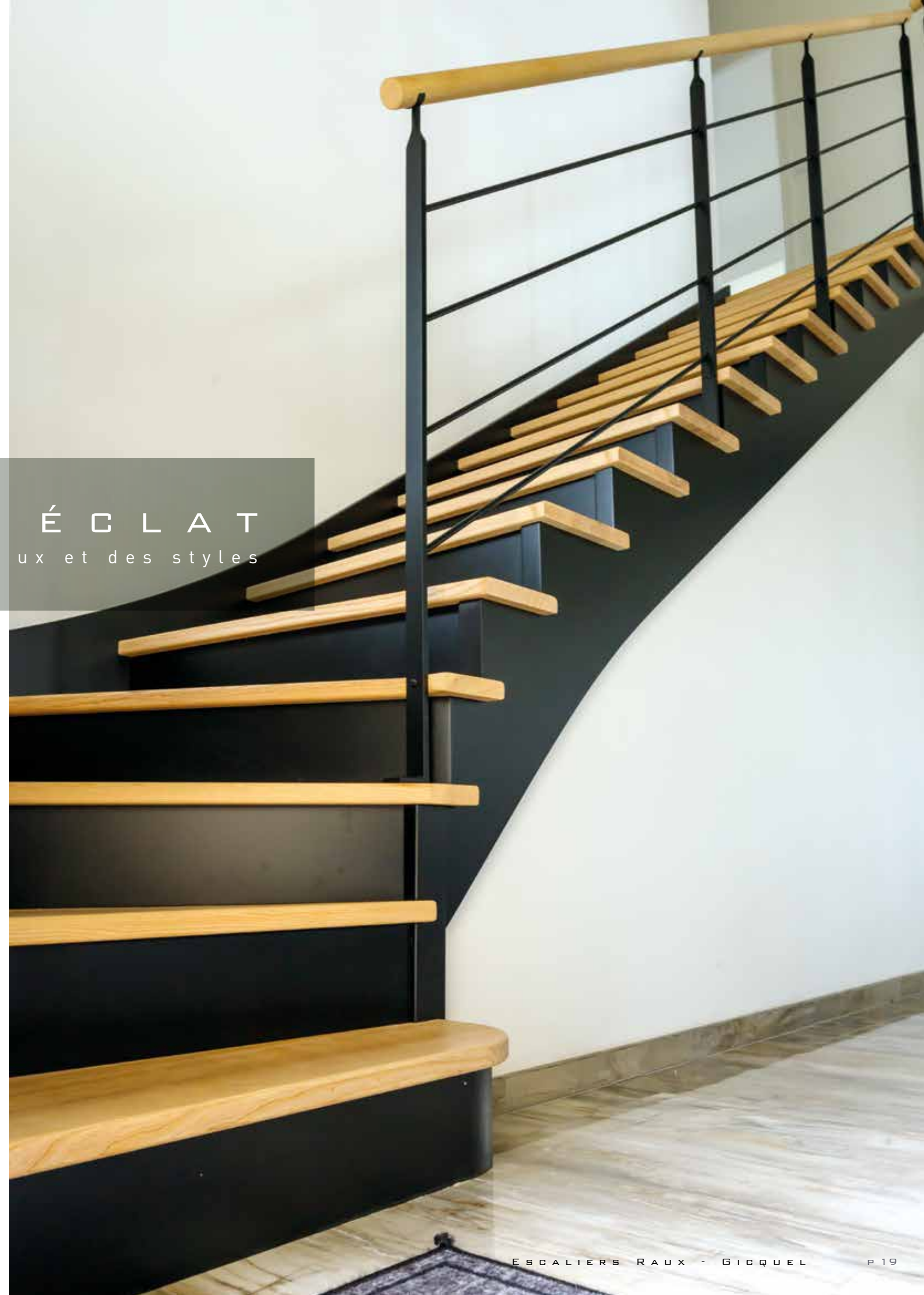
Me-6 ➤ Escalier 1/4 tournant en Frêne Olivier avec contremarches, marche de départ S3, main-courante MCR, sur crémaillère "à l'anglaise" et limon de mur.
