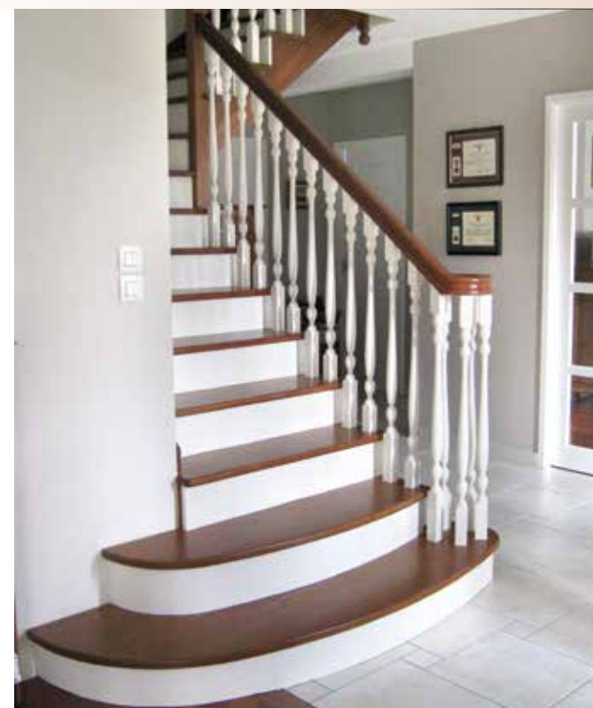
➤ ➔ Tr-3 : Escalier 1/4 tournant en Sapelli avec contremarches, marches de départ S8, départ T8, balustres tournés, main-courante MC1, sur crémaillère "à l'anglaise" avec limon de mur.
